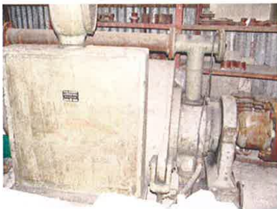
Slika br.37. i 37.1. Kočnica za ispitivanje motora, CARL SCHENCK
