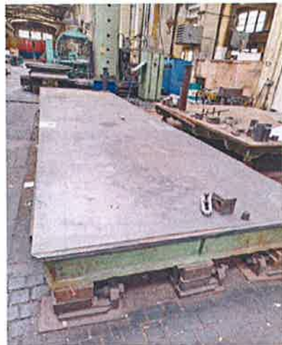
Slika br. 10. Ploča za ocrtavanje 8000 x 2000 mm
