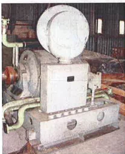
Slika br.36. i 36.1. Kočnica za ispitivanje motora, CARL SCHENCK
