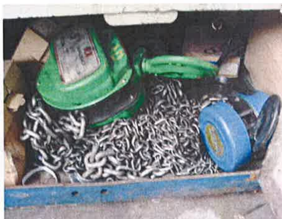
Slika br.111, Dizalica lančana 5 t - zelena i br.112, Dizalica lančana 2 t - plava
