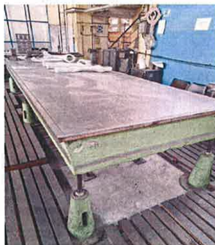
Slika br. 05. Ploča za ocrtavanje 1000 x 1000 mm
