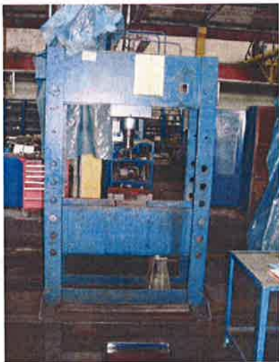
Slika br. 12. Preša hidraulična 1 t
