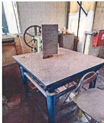
Slika br. 05. Ploča za ocrtavanje 1000 x 1000 mm
