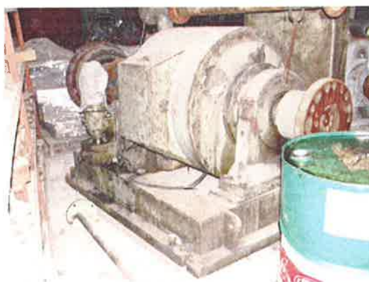
Slika br.37. i 37.1. Kočnica za ispitivanje motora, CARL SCHENCK
