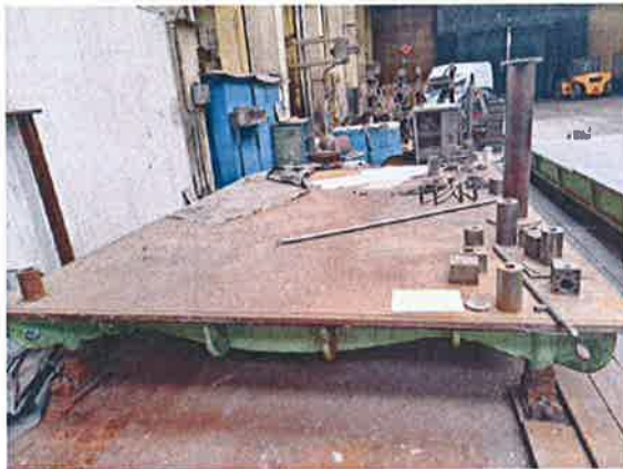
Slika br. 09. Ploča za ocrtavanje 4000 x 3000 mm
